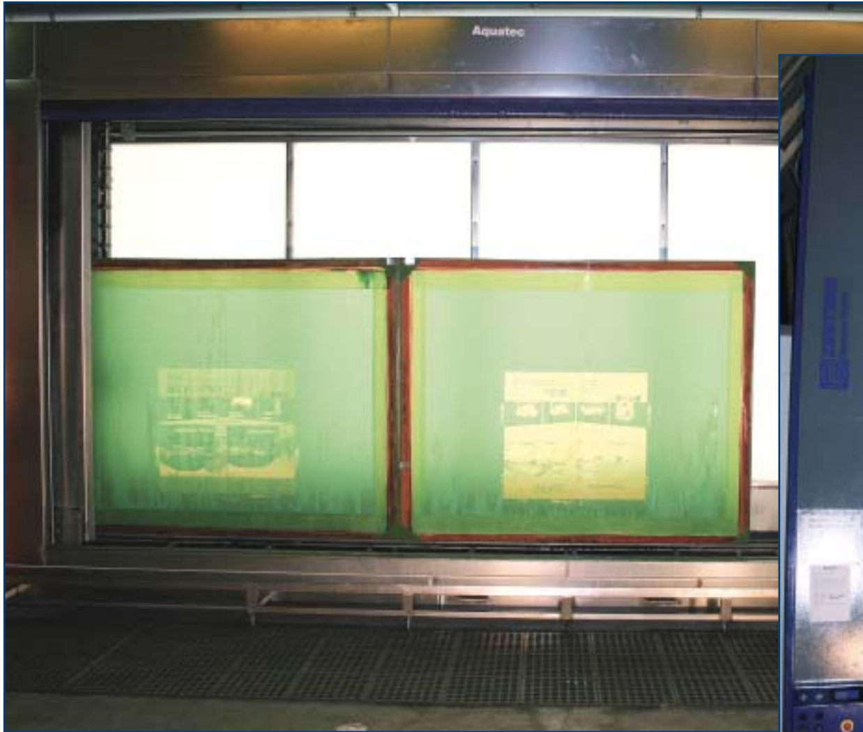
■ ■ ■ Entwicklungsanlage max. Siebformat 2100 mm x 4600 mm
