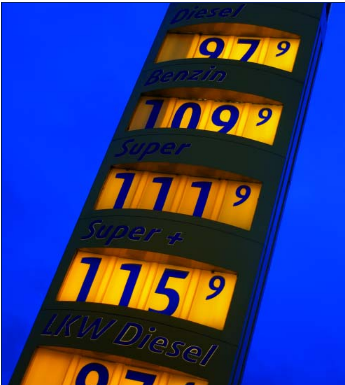
■■■ Rollbandanzeige in einer Tankstellenpylone
