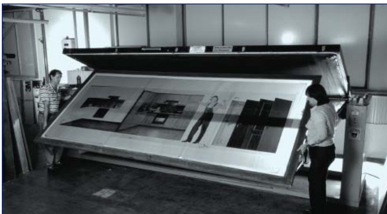
■■■ Schablonenherstellung über Filmmontage
